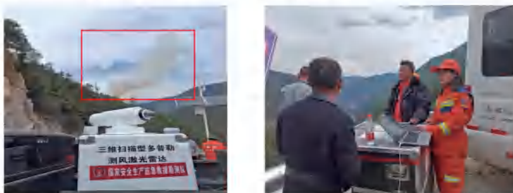
研制的多普勒测风激光雷达在雅江火灾现场进行风场监测
