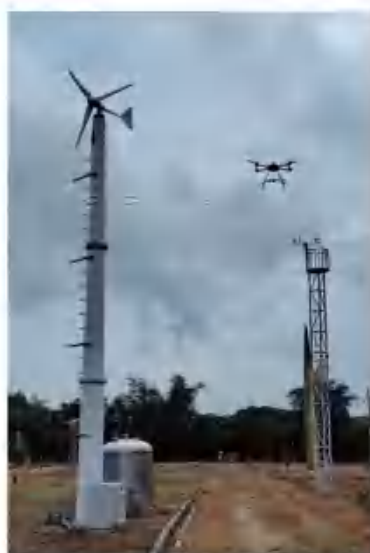
部分雷击防护测试目标物及 空中电场无人机测量
