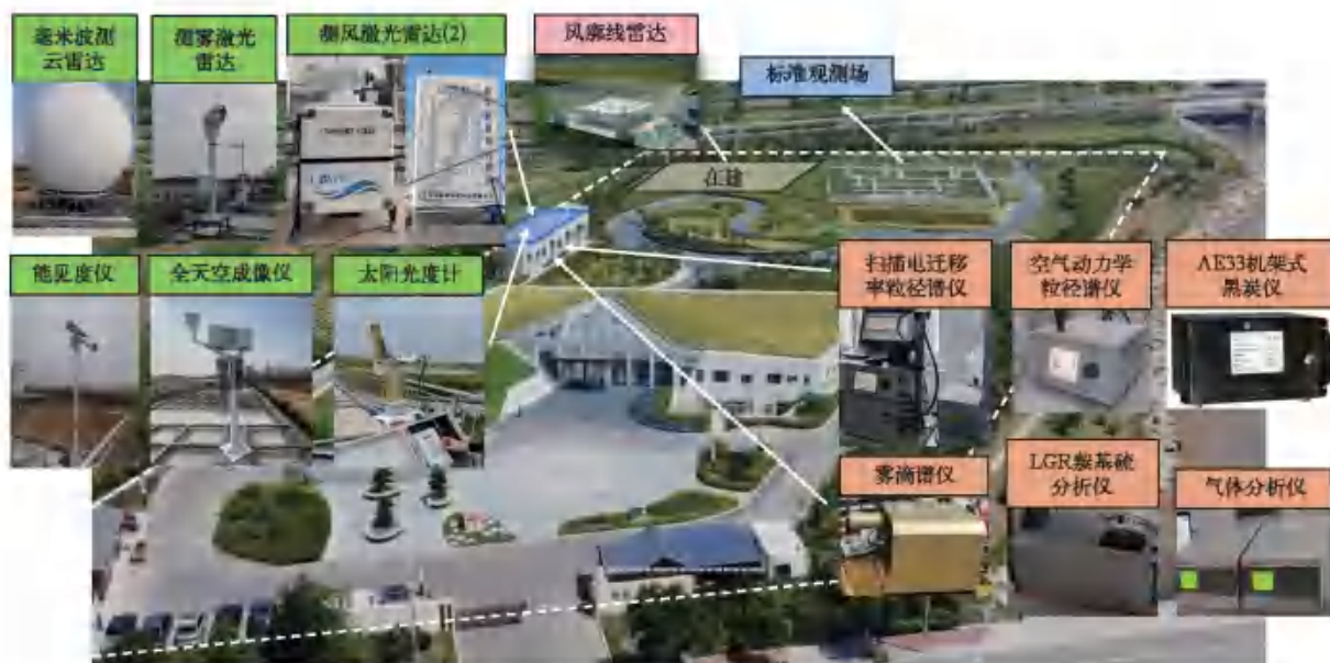
黄海海雾综合观测试验观测设备布局
