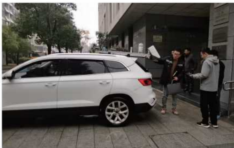
交通气象车载监测设备在宿淮盐高速开展应用试验
